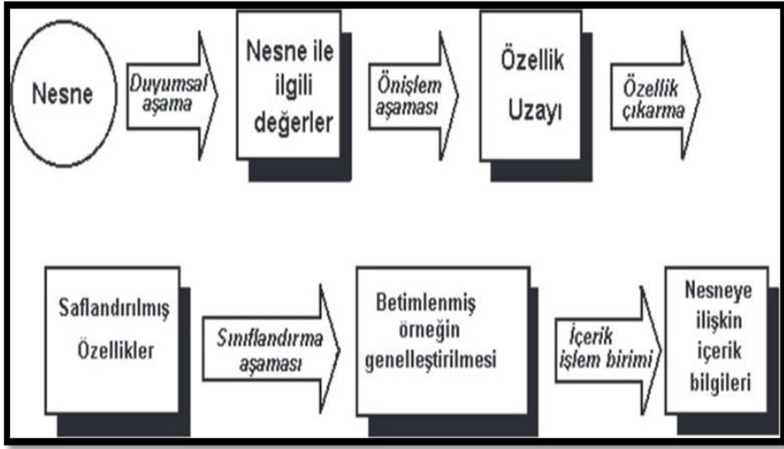
Şekil 4.7. Yüz tanıma biyometrik sisteminin işleyişi (Nabiyev, 2016, s. 48)
